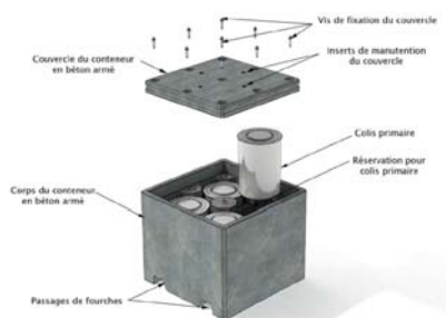
Illustration de la mise en conteneur de stockage de colis de déchets MA-VL
