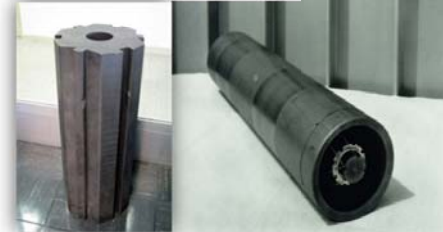
Briques et chemises de graphite
